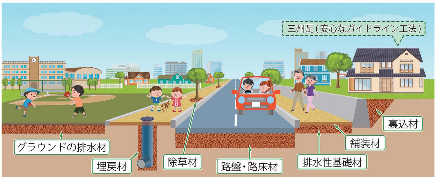
シャモットの土木資材としての利活用方法
